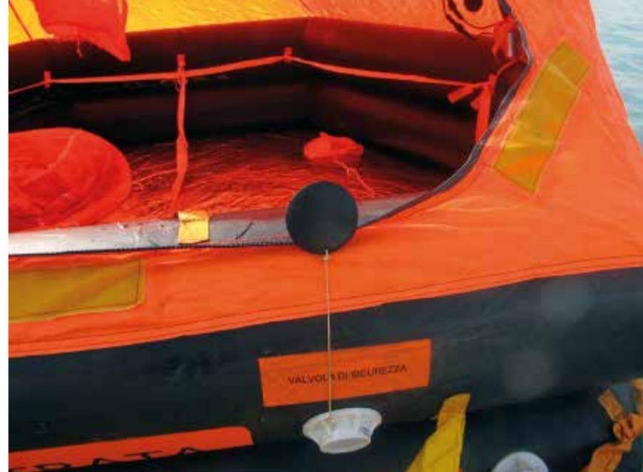
Le valvole di sicurezza da chiudere una volta saliti a bordo.
