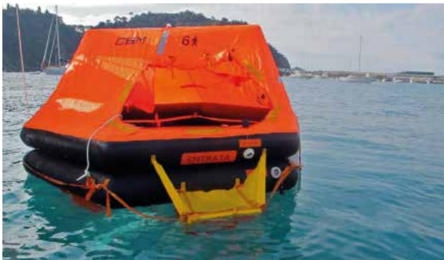
L'apertura principale della zattera e il gradino giallo che, oltre a consentire la risalita dal mare, permette di esercitare una leva con il peso del corpo per un eventuale raddrizzamento.
