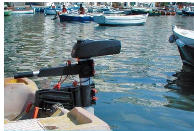
L'unico sistema ecologico attualmente disponibile per il piccolo cabotaggio e per navigare nelle aree marine protette: utilizzare un piccolo fuoribordo elettrico, con batteria incorporata nella testa, ricaricabile dalle prese elettriche di casa.
