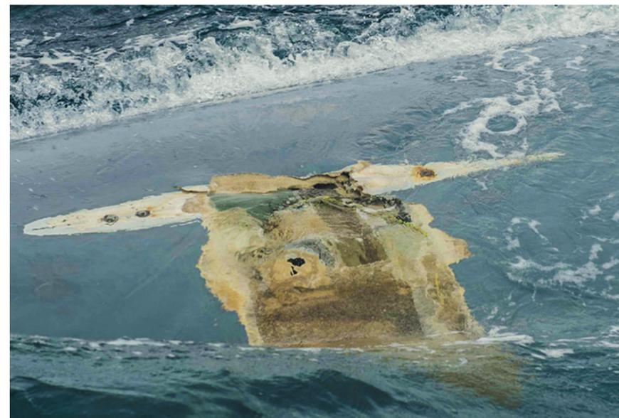
go si arrampica sulla barca capovolta e inizia a battere per capire se il suo compagno stava bene e così era. Ora gli è anche evidente l'accaduto: il bulbo si è staccato di netto, probabilmente a causa dell'impatto con un corpo semisommerso. Due giorni dopo sarà avvistato un container alla deriva nella stessa area di
